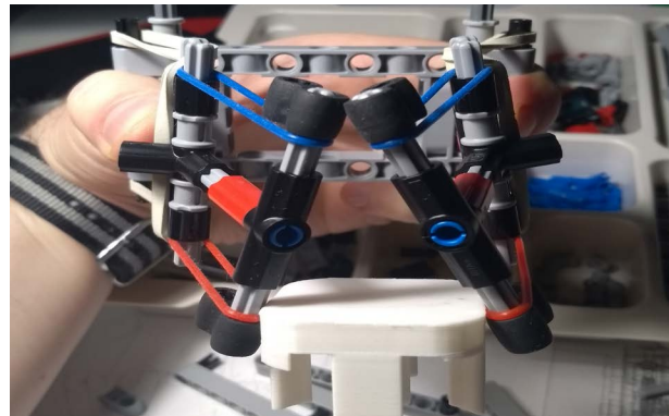
Rys.105: Działanie wychylnych osiowo dźwigni-szczypców
