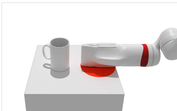
Rys.187: Auto zatrzymanie po kolizji i wycofanie ruchu.
