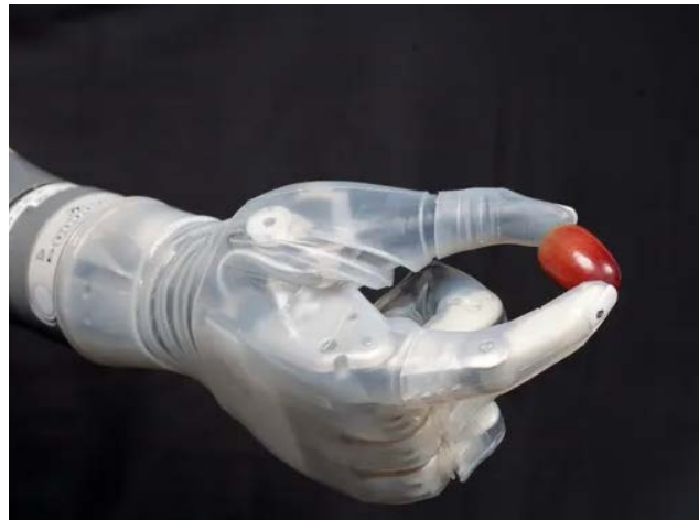
Rys.164: DEKA bionic arm. Sylikonowe poszycie konstrukcji. Źródło: https://www.wevolver.com/specs/deka.bionic.arm .
