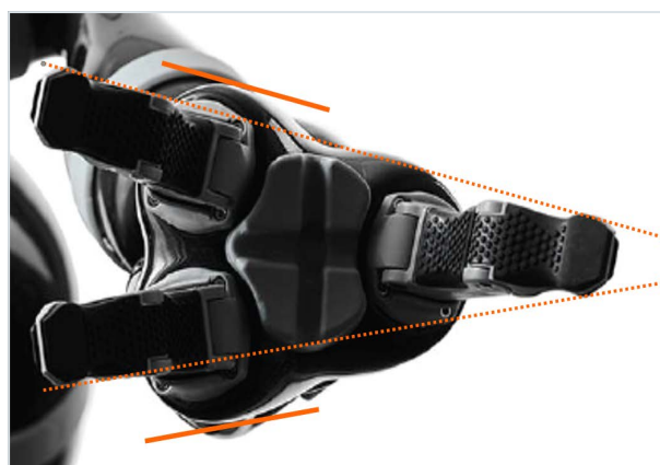
Rys.31: Chwytak Jaco, brak równoległości palców
