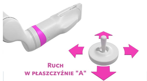
Rys.184: Sygnalizacja LED o wybranej powierzchni ruchu.
