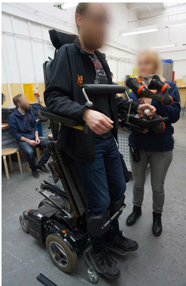
Rys.71: Ramię Bateo zamontowane na wózku
