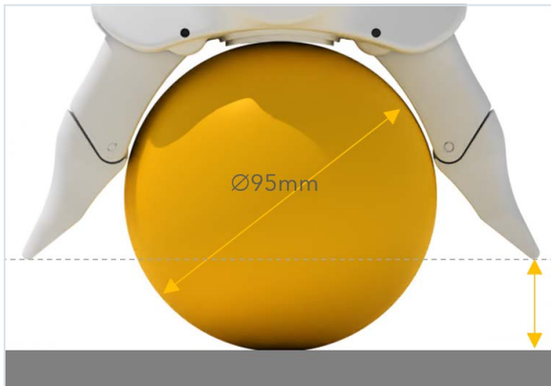
Rys.33: Chwytnie Bateo, maksymalna średnica przedmiotu
