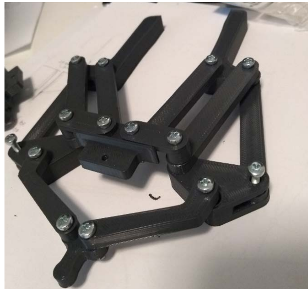
Rys.127: Wydrukowany uproszczony model palców.
