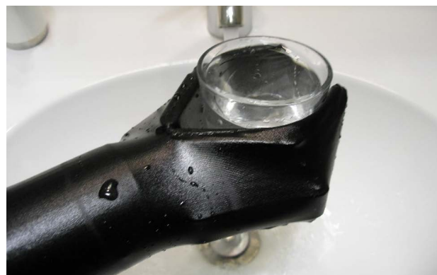
Rys.172: Weryfikacja wodoodporności rękawicy.
