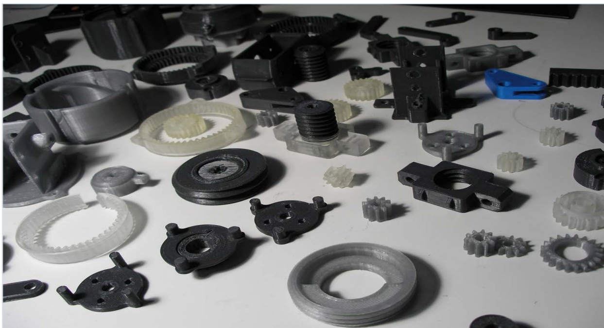
Rys.140: Zbiór wadliwych części z etapu powstawania konstrukcji.
