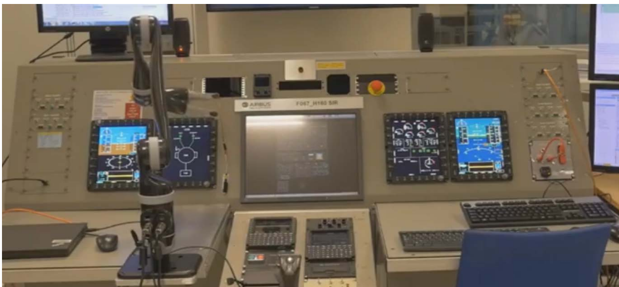
Rys.7: Ramię Jaco w zautomatyzowanych testach Airbus Helicopter, Źródło: https://www.youtube.com/@Kinovarobotics
