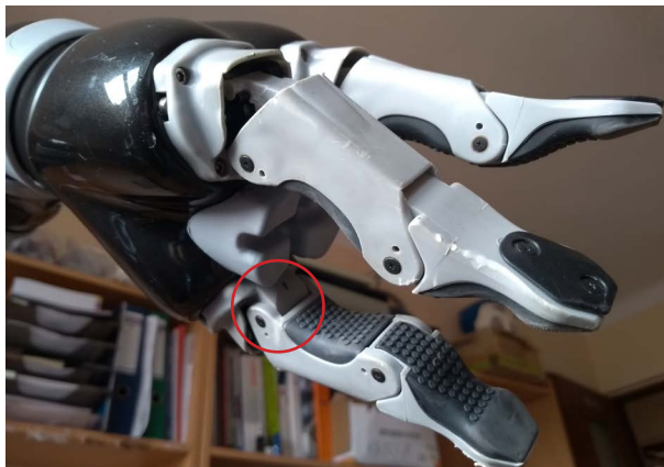
Rys.65: JACO, widoczne otarcia i ślady zmęczenia materiału
