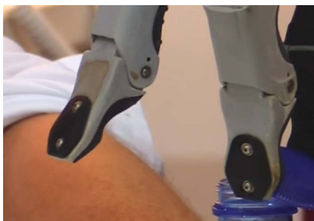
Rys.66: Palce JACO, noszące stare zabrudzenia
