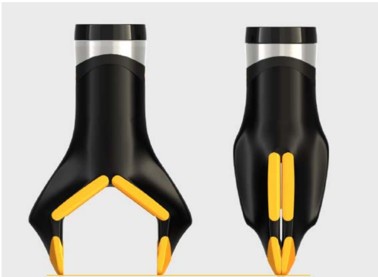
Rys.215: Otwarcie/zamknięcie chwytaka nie wpływa na zmianę odległości od blatu.
