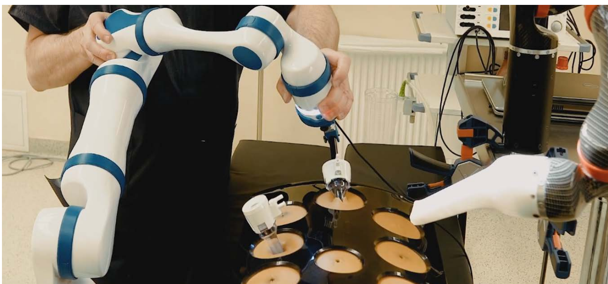
Rys.8: Wariant ramienia Bateo podczas symulacji operacji laparoskopowej, Źródło: https://www.accrea.com
