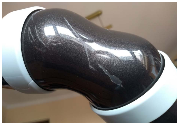
Rys.68: Nadgarstek JACO, uszkodzenia lakieru.
