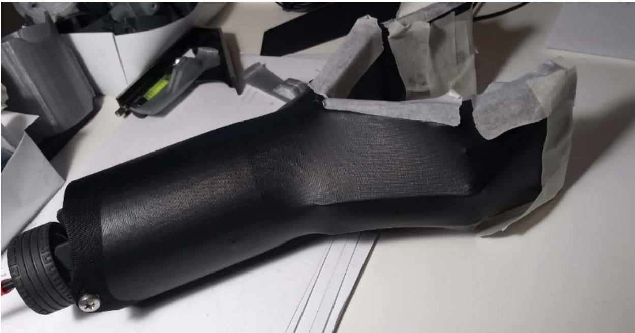
Rys.169: Prototyp poszycia z materiału spandeks. Taśma papierowa imituje gumowane części chwytne.
