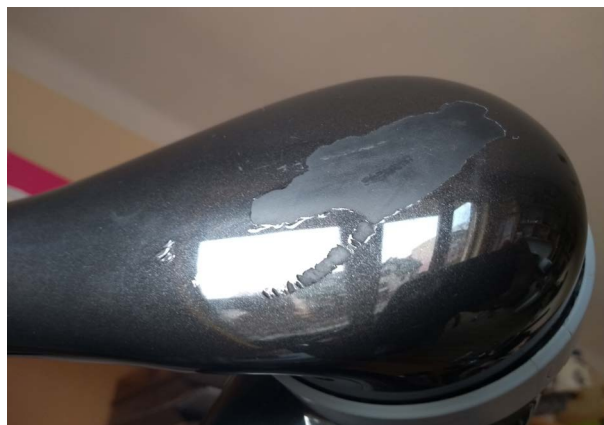
Rys.69: JACO, uszkodzenia lakieru.
