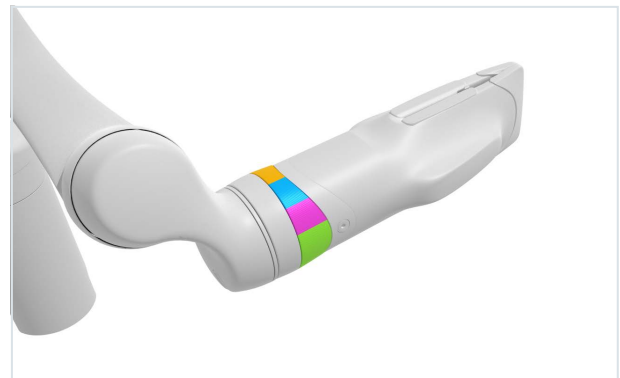
Rys.183: Komunikacja światłem LED - kolory i impulsy.
