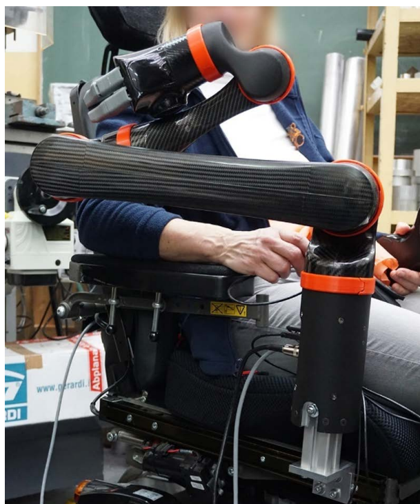
Rys.70: Ramię Bateo zamontowane na wózku
