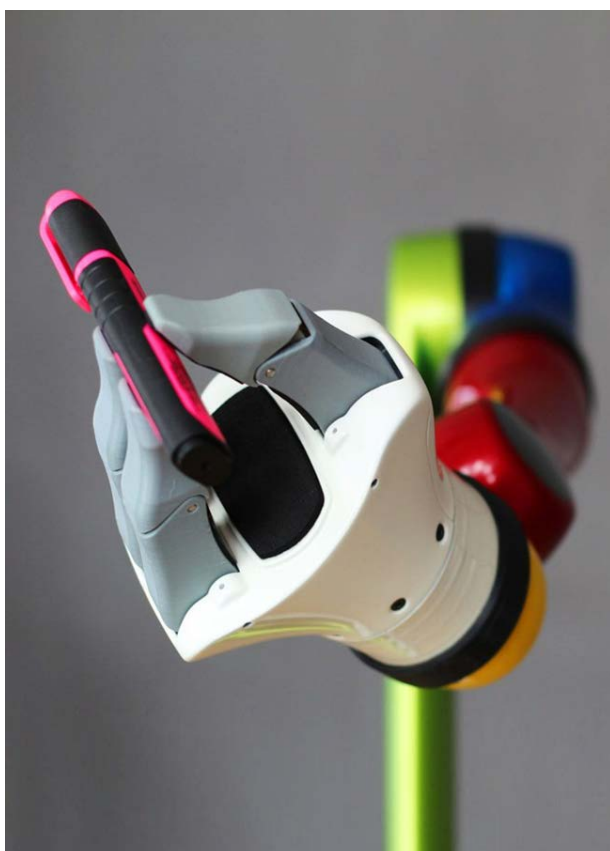
Rys.25: Chwywak Bateo trzymający flamaster
