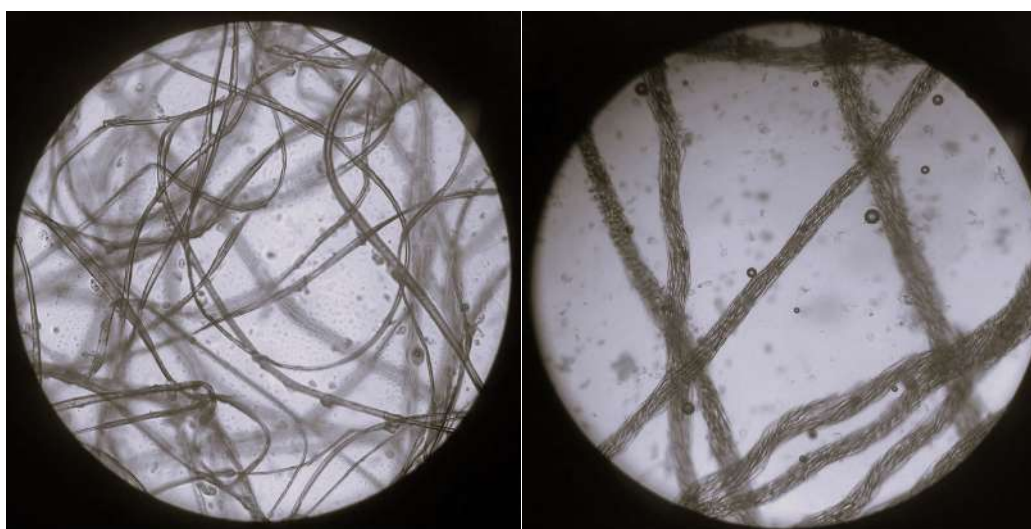
fot.6,7. Zdjęcie mikroskopowe surowego jedwabiu (z lewej) i włókien jedwabiu (z prawej) 2021 r. źródło: archiwum autorki
