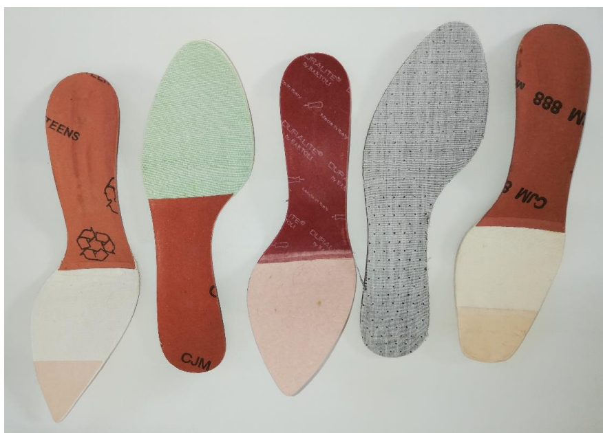
Ilustracja 79. Przykładowe rodzaje podpodeszew wykorzystanych w pracy badawczej.
